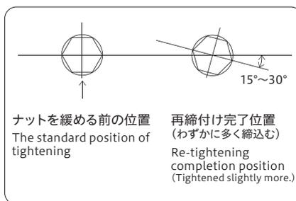
注意:プラスチックチューブ使用時の再締付けにつきましては、1/8～1/4回転で締付けてください。
