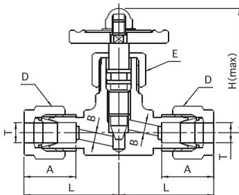
ステンレス製締付継手
