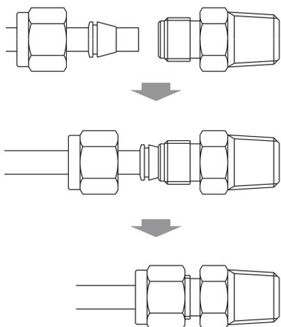
① ナットを緩める前にナットの位置を確認してからナットを外してください。(基準の締付け回転位置)
