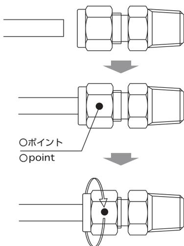
① ナットを外さずに、そのままパイプを継手の中に差し込み、パイプ先端を継手内部の肩にあたるまで、差し込んでください。(注:パイプは直角に切断し、端面の内外のバリは完全に除去してあるか確認してください。)
