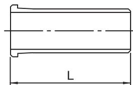
W-INTERLOCK JOINTにプラスチックチューブを接続する際に、ご使用ください。
