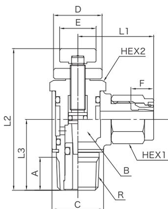
・Oリングには乾燥性組付け用ワックスを使用しています。 ・The O ring uses a dry assembly wax.
