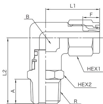
・Oリングには乾燥性組付け用ワックスを使用しています。 ・The O ring uses a dry assembly wax.
